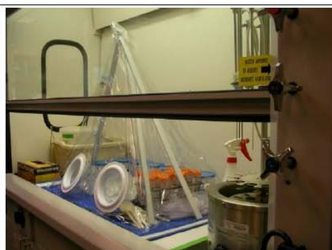
ドラフトの中でさらに危険物質を扱うためのフードカバー。
